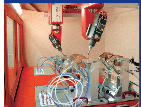
Double independent bridge for parallel machining Niezależny podwójny most do obróbki równoległej
