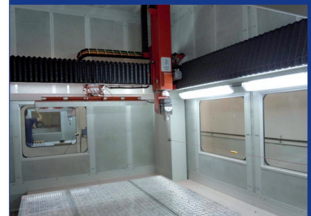
Aluminium vacuum table with T slots Aluminiowy stół próżniowy z rowkami teowymi
