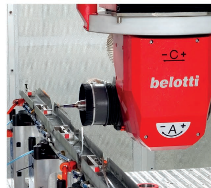
Motorized dust suction hood Kaptur ssący z napędem silnikowym
