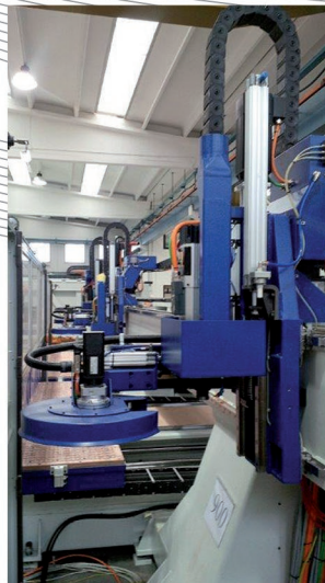
6-position tool change 6-pozycyjny zmieniacz narzędzi
