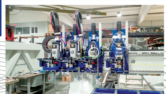
Independent 4 heads structure with tool change Niezależna 4 głowicowa konstrukcja zezmianą narzędzia
